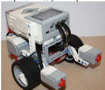
Рисунок 1 - Робот, обучающийся объезжать препятствия
